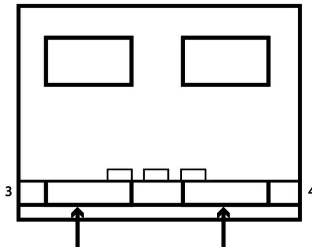
Ripiegare il telo in PVC come in figura e foto, in linea con la parte in PVC della camera precedentemente ripiegata (punti 3-5 / 6-4).
