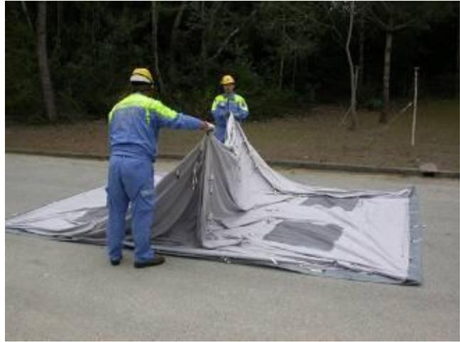
Dopo avere sollevato il telo camera riponetelo come in figura e foto, facendo attenzione di infilare la parte sbordante lateralmente sotto il telo riposto.
